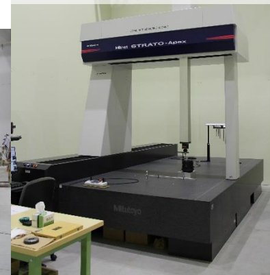
一般検査場(左)、恒温室に設置された三次元測定機(右)
