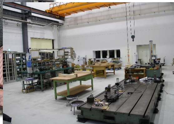
一般検査場(左)、恒温室に設置された三次元測定機(右)
